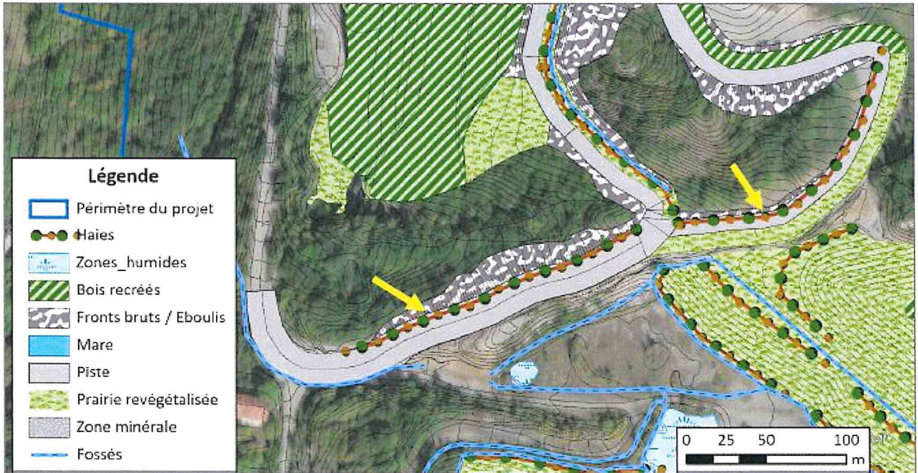
Mesure MA8f : aménagements spécifiques en faveur de la biodiversité sur la piste d'accès de Pierre Grosse, à l'issue de la remise en état
